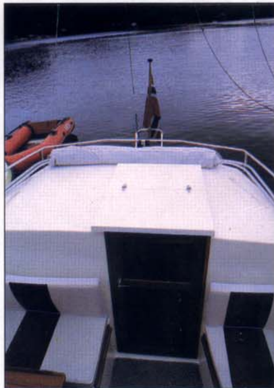
Nedgangen til akterlugaren har fått moderne brettbar luke (bildet nærmest). Ellers er de to akterpartiene nokså like, bortsett fra den nye badeplattformen og sikkerhetsrekka som Alf har montert selv.
